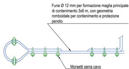
Fune Ø 12 mm per formazione maglia principale di contenimento 3x6 m, con geometria romboidale per contenimento e protezione pendio
