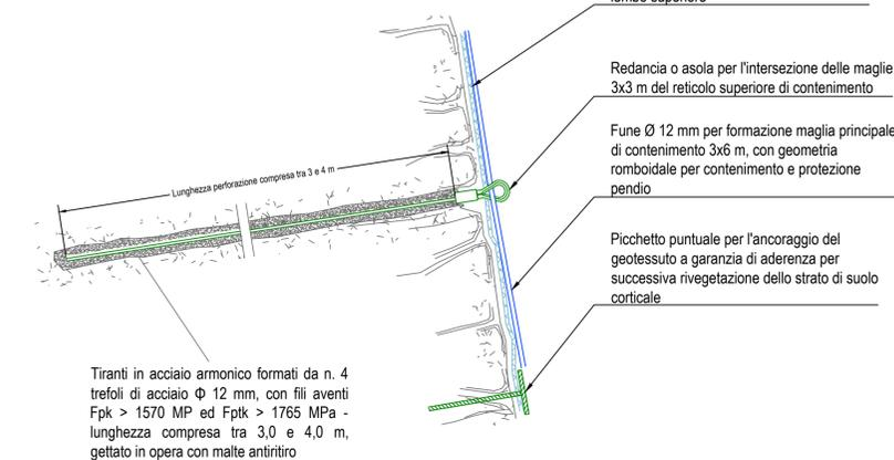
Rete metallica a doppia torsione con maglia esagonale, risvoltato in corrispondenza del lembo superiore
