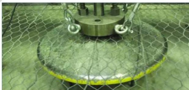
Figura 3: Prova di punzonamento
