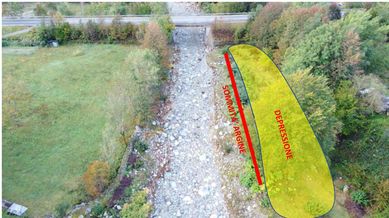
Tale fenomeno, col perdurare della situazione, può indurre scalzamento del manufatto creando instabilità al piede dello stesso destabilizzando il rilevato della provinciale. Volendo pertanto preservare l'equilibrio geostatico dell'opera, pur ricadendo in fascia di rispetto, con gli interventi in progetto si propone di colmare tale depressione in area golenale e proteggere con apporto di materiale grossolano il fronte dell'opera di sostegno a salvaguardia della stessa.
