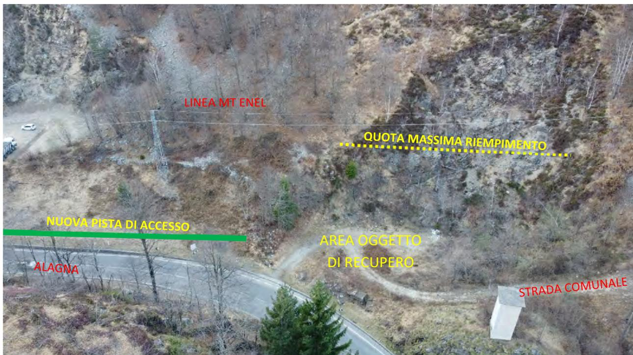
L'intervento prevede l'accumulo del materiale litoide, prelevato circa 1 km più a valle, e la sua successiva stratificazione in tre terrazzamenti con altezza massima pari a 3 metri l'uno. Il materiale verrà profilato con scarpate aventi pendenza di circa 30°, corrispondenti a poco meno dell'angolo di attrito interno del materiale litoide e tra una scarpata e l'altra, verrà lasciata una zona pianeggiante di circa 3,00 metri.
