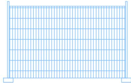
Recinzione in pannelli con tamponatura in rete elettrosaldata fissata a terra su base in calcestruzzo + rete in polietilene ad alta densità di colore arancio
