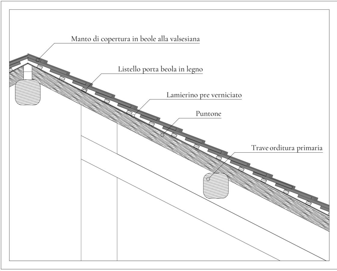
DETTAGLIO COPERTURA NON ISOLATA
